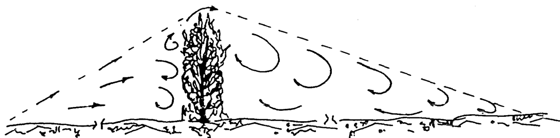
Figura 5. Torbellinos formados por la acción de un cortaviento impermeable
